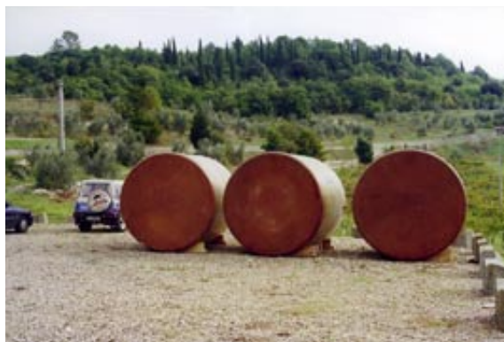
Les 3 cuves en PVC en attente sur le parking
